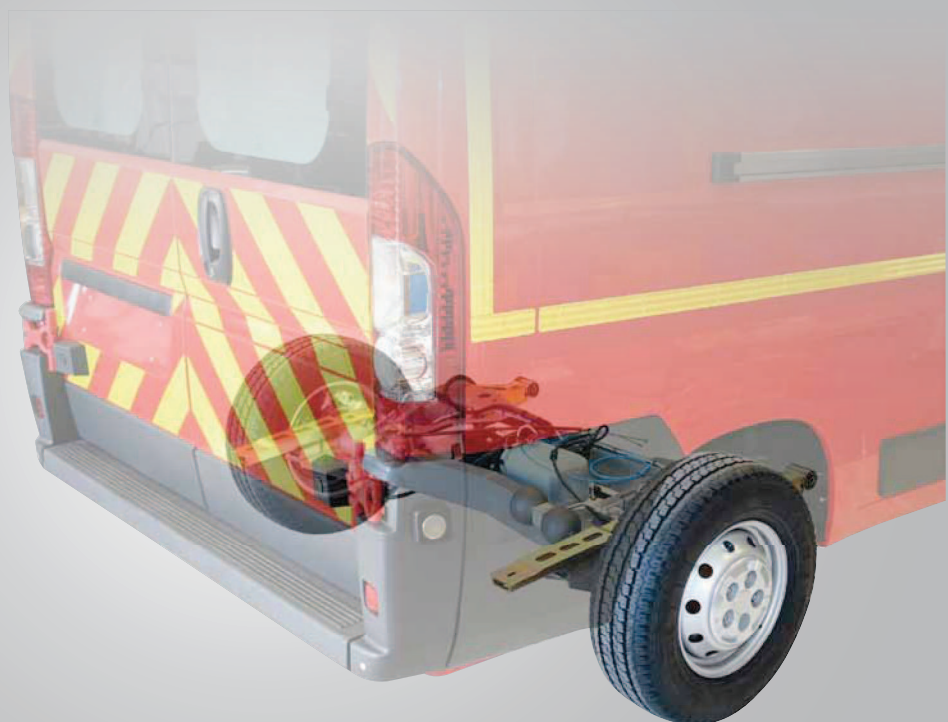
Suspension hydropneumatique à 4 sphères - amortisseurs
