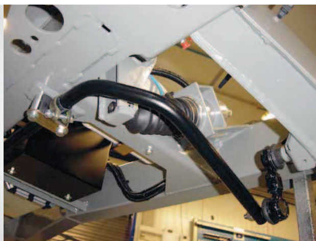
Essieu arrière à bras tirés et barre anti roulis
